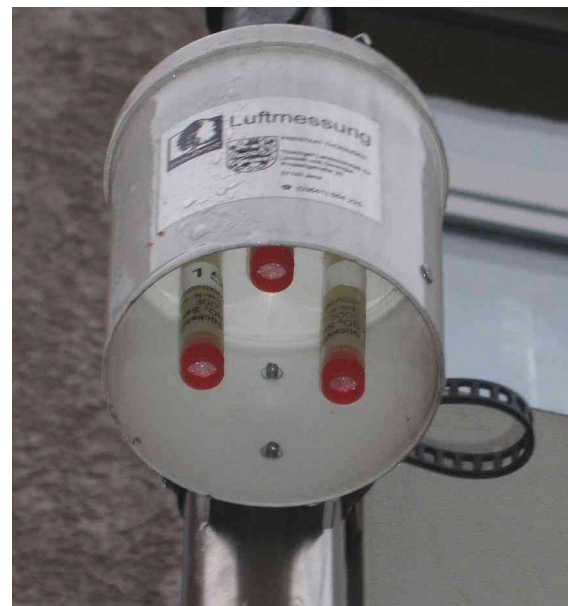
Abb. 7: Passivsammler für Stickstoffdioxid
