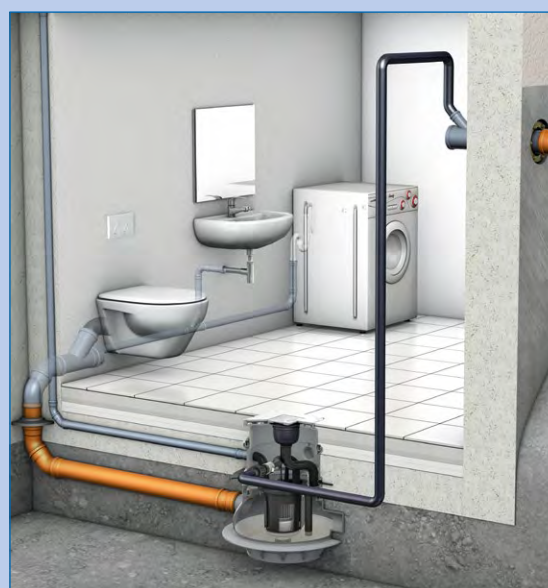
Abb. 39 Funktionsprinzip einer Hebeanlage
