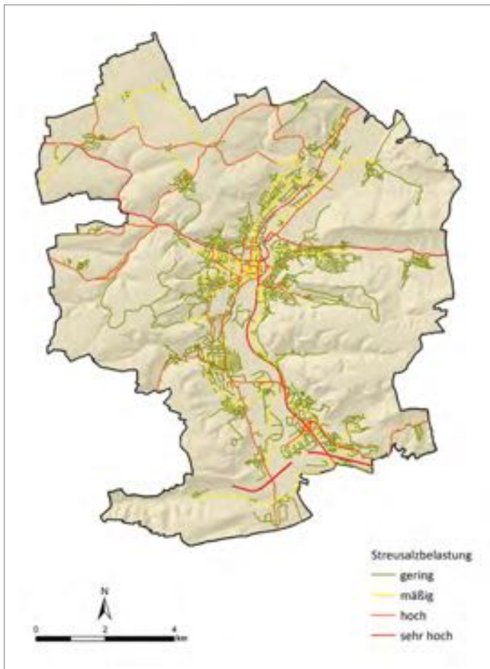
Abb. 30: Standortparameter »Belastung durch Auftausalze«
